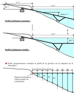
La méthode est simple, il suffit de rendre à partir d'un point de référence, une corde, par exemple à la surface de l'eau. Ce dernier étant gradué avec les mètres. On place ensuite un autre point vertical avec un poteau que l'on place à chaque mètre afin de relever la profondeur avec une balance de 0 à 10m.
